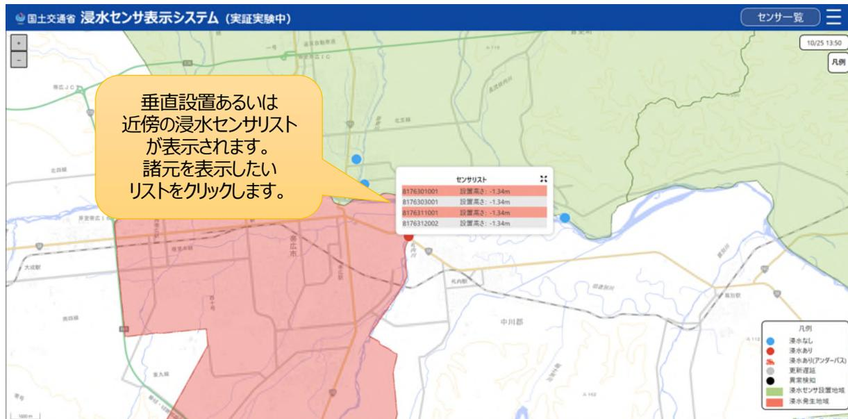
リストをクリックするとクリックした浸水センサの諸元が表示されます。
